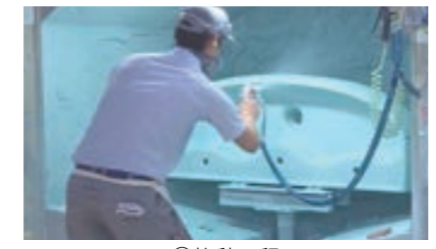
③施釉工程
